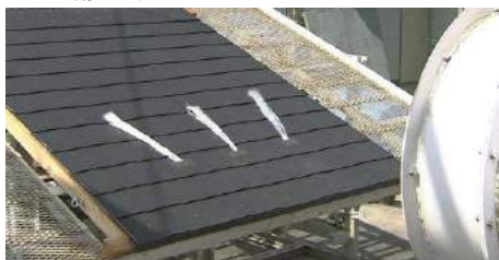
■ 正圧耐風試験 (社内試験)
